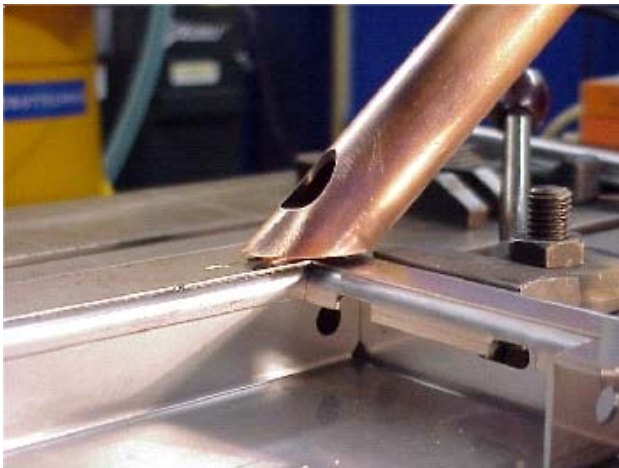
figuur 4.9 Mogelijke uitvoering van een koperen gasbuis ter bescherming van het smeltbad en de las tegen negatieve inwerking van de omgevingslucht (oxidatie). Door het gat in de buis kan de laserbundel het werkstuk bereiken
