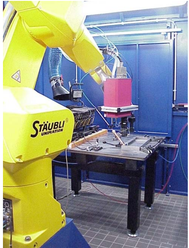
figuur 7.5 Opstelling van een 6-assige knikarmrobot met daaraan de diodelaser
