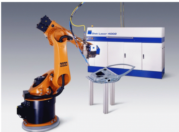
figuur 2.11 Knikarmrobot met remote scansysteem
