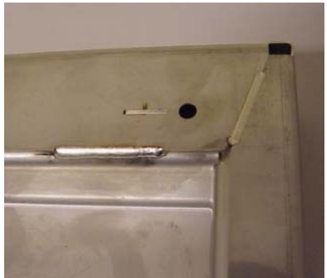
figuur 7.6 Hoeksegment van het gelaste paneel met daarin een stompe las en een hoeklas (zonder toevoegmateriaal)
