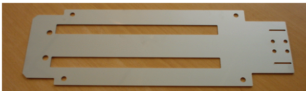
figuur 7.1 Uitslag van een zijgeleiding van een dozenopzetmachine voor de verpakkingindustrie. Materiaal RVS 1.4301. Dikte 2 mm. Afmeting 446,3 x 146,6 mm 2
