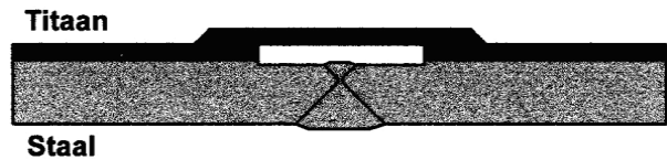
figuur 6 Lasverbinding in met titaan beklede staalplaat
