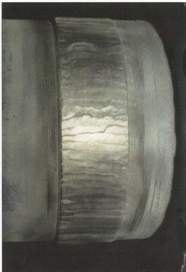
figuur 9.32 Afsluitring (Ø 400 mm) van een pendelmolen
