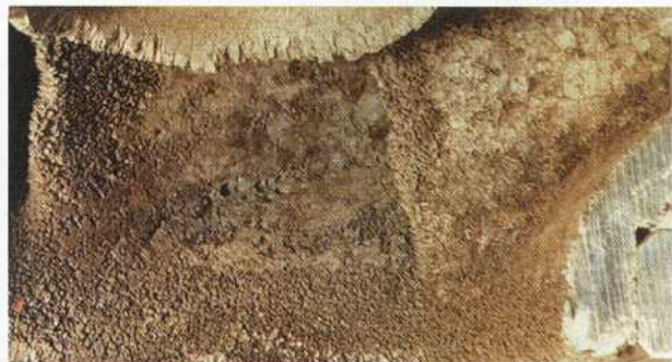
figuur 7.12 Voorbeeld van interkristallijne corrosie
