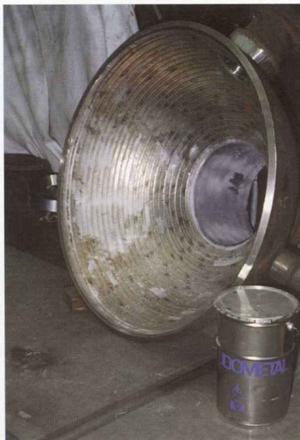
figuur 9.9 Bodem van een drukvat voor de chemische industrie
