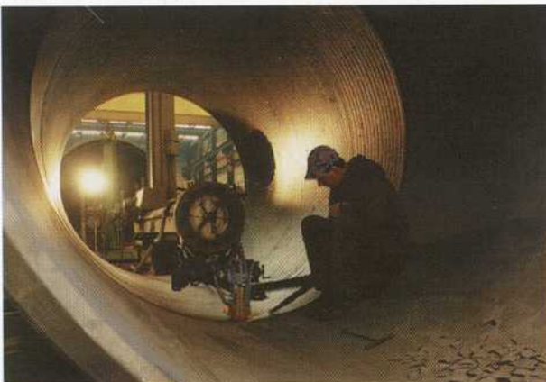
figuur 9.15 Drukvat voor de aardgasproductie (foto: Welding Alloys Nederland, Beverwijk)
