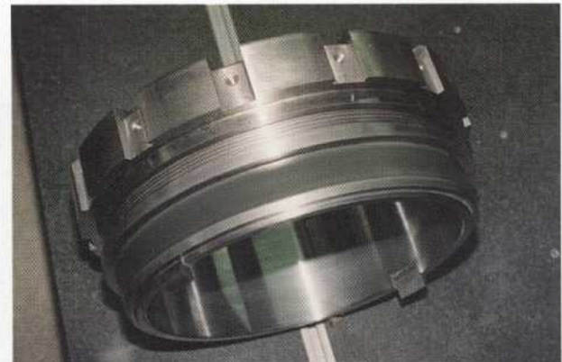
figuur 9.26 Moerset (drukkring) t.b.v. axiale lagerspeling inbouwstukken werkwalslagering
