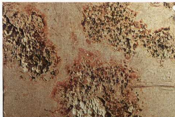
figuur 7.9 Voorbeeld van selectieve aantasting
