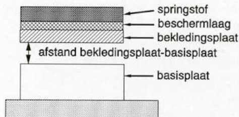
figuur 5.8 Het principe van explosief omlassen
