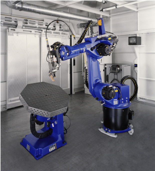
figuur 2.8 Voorbeeld van een 6-assige industriële robot met externe draai-kiep manipulator (bron: Trumpf Laser GmbH)
