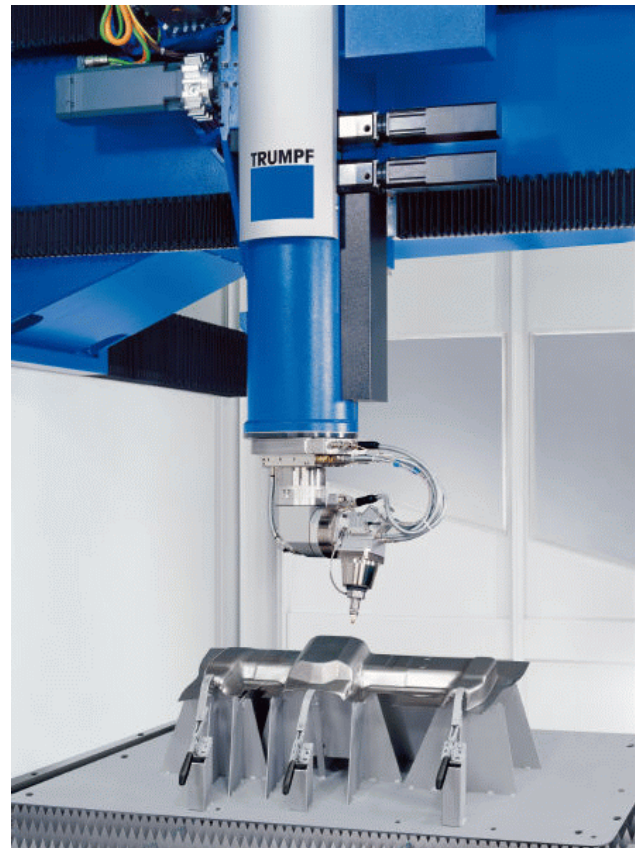
figuur 2.5 Voorbeeld 5-assig gantry systeem met XYZ-as voor positie en bc-as voor oriëntatie (bron: Trumpf Laser GmbH)
