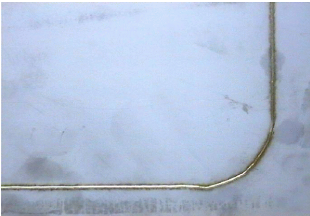
figuur 2.3 Voorbeeld van een eenvoudig product (vlakke plaatdelen) met een moeilijke laslasnaad (radius ~ 30 mm)
