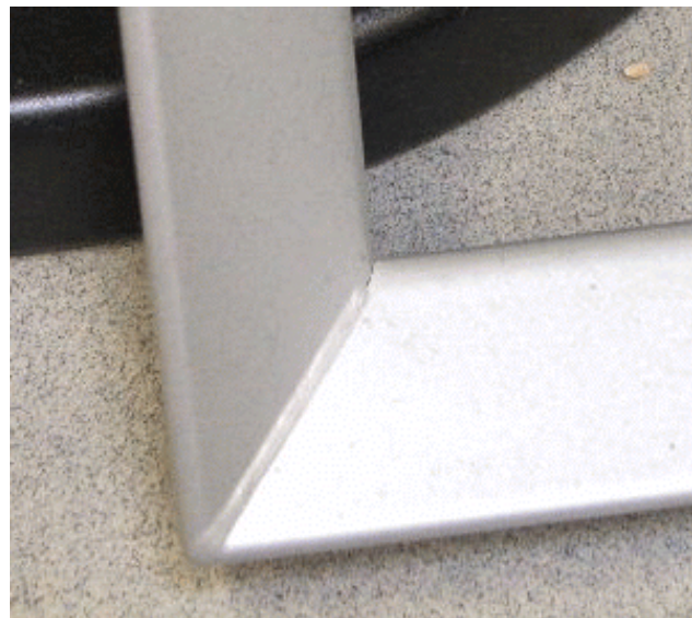
figuur 5 Het zichtbaar blijven van lasrupsen na het lakken
