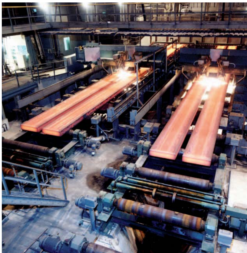
Een continu gietmachine bij Corus IJmuiden; het gieten van twee plakken per streng
