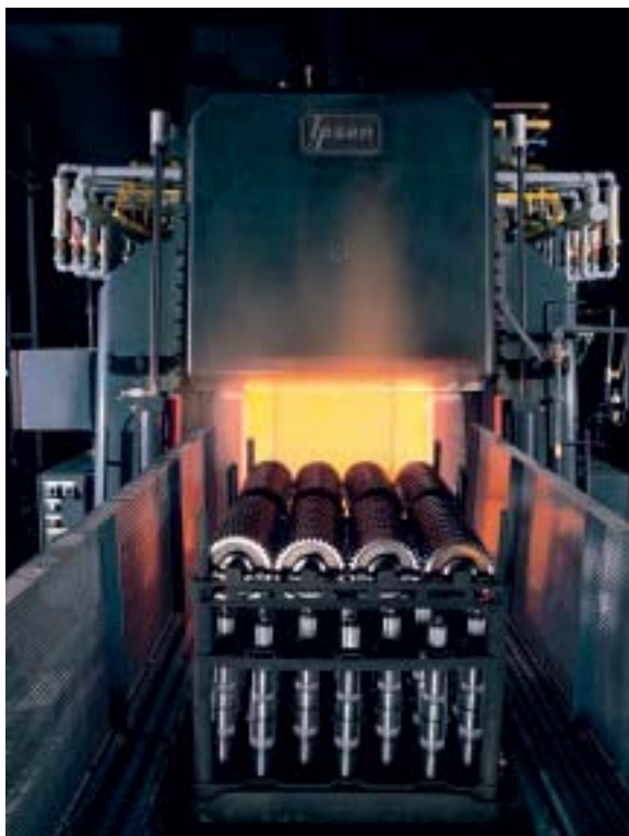
Onderdelen gaan de oven in voor een warmtebehandeling bij Bodycote, een bedrijf dat al meer dan 25 jaar specialist is op het gebied van warmtebehandelingen (foto: Bodycote)
