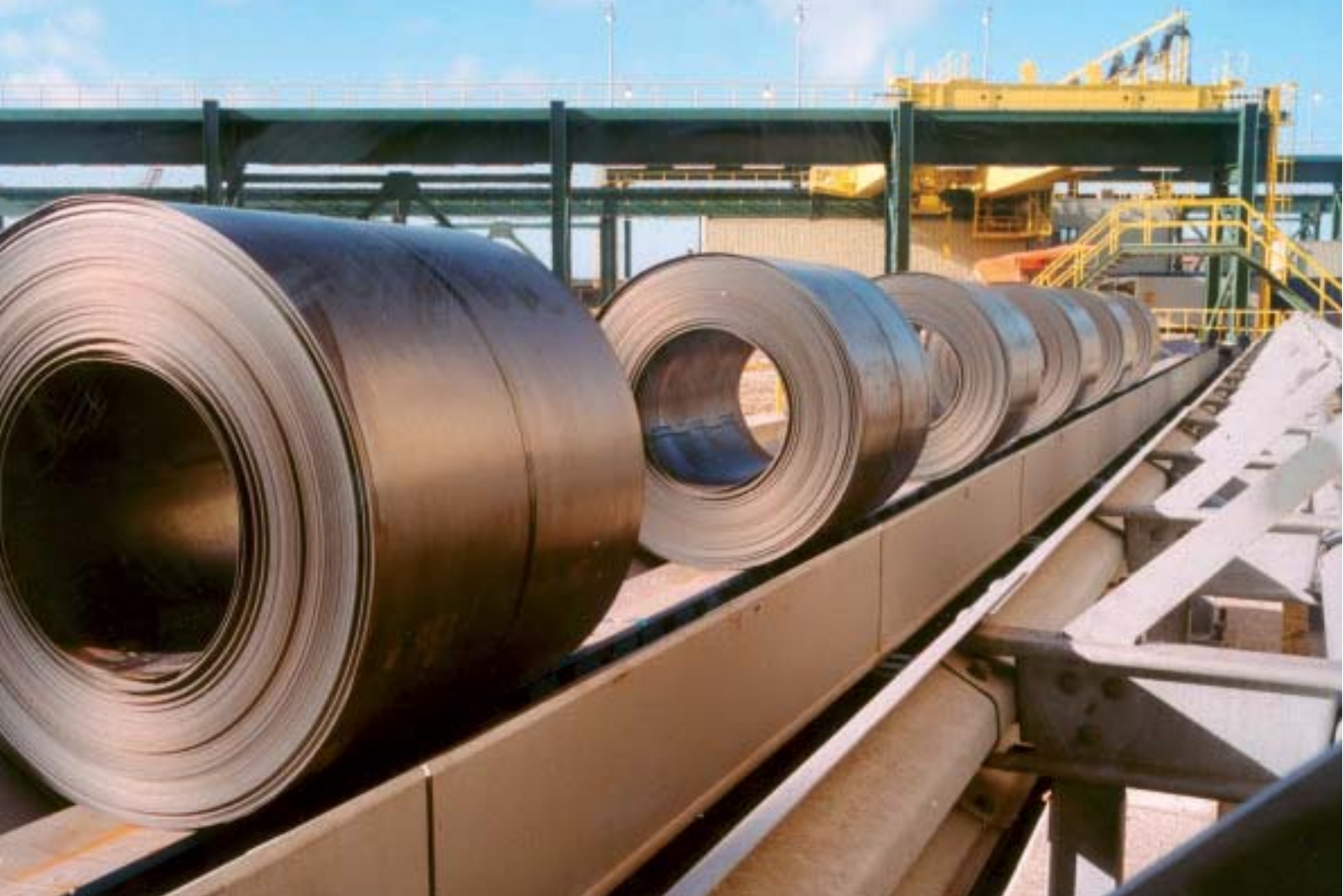
Figuur 3 - Thermomechanisch gewalste rollen bij Corus IJmuiden uit de Direct Sheet plant (DSP). Deze plant produceert per jaar circa 1,2 miljoen ton hoge sterktestaal, waaronder S550MC (Ympress)
