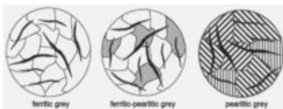
Figuur 8 - Schematische weergave van de belangrijkste verschijningsvormen van grijs gietijzer
