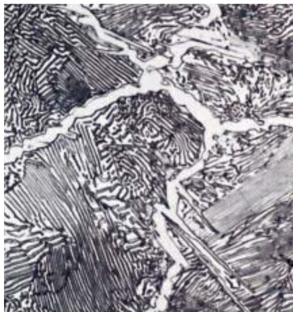
Figuur 1 - Links perlietkolonies in eutectoidisch staal en rechts proeutectoidisch cementiet netwerk en perliet in bovenperlitisch staal (1.1 gew.% C)
