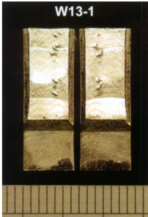
Figuur 4 - Breukvlak van een CTOD-buigproefstuk. De machinaal vervaardigde kerf bevindt zich aan de onderkant. Het einde van de vermoeiingsscheur (lichter deel) is niet recht, maar enigzins gebogen.
