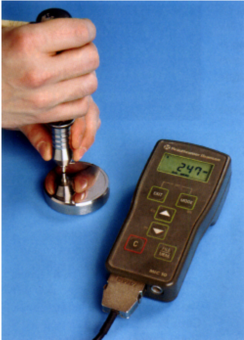
Figuur 3 - Ultrasoon hardheidstest met een microdur unit.
