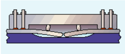
Figuur 2: Voorbuigen van de plaat door gebruik te maken van bruggen en keggen om lasvervorming door hoekverdraaiing te compenseren.
