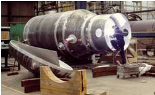
Foto 1. AC TIG lassen van een cryogeen drukvat in aluminium (Air Products)
